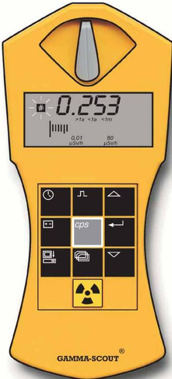
Der GAMMA-SCOUT® verfügt über eine integrierte Quarzuhr (Anzeige auf Tastendruck). Uhrzeit/Datum dienen zur korrekten Protokollierung der gemessenen Strahlung. Mit einer Funktion im Datenausleseprogramm der TOOLBOX-Software kann die Zeit an die Uhr Ihres PC angepasst werden. Wählen Sie hier den Menüpunkt „Beliebig stellen“, um Datum und Uhrzeit des GAMMA-SCOUT® nach Belieben (z.B. in anderen Zeitzonen) einzustellen.
